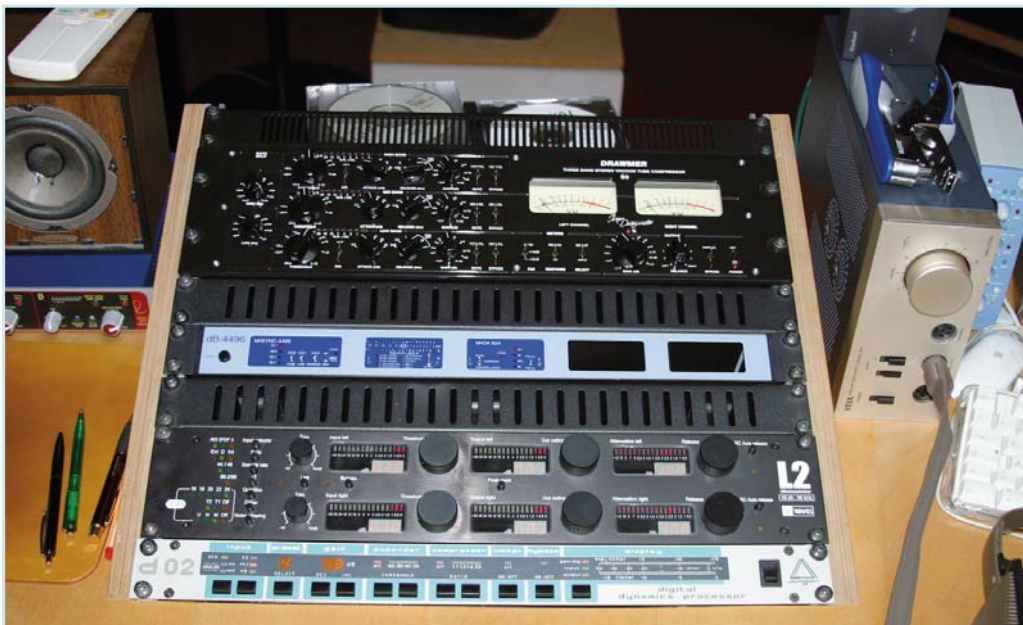
Eines der zwei in den Arbeitsplatz integrierten Equipment-Racks enthält den S3 von Drawmer als Neuzugang neben alten Hasen im Mastering-Business wie dem A/D-D/A-Wandler von db Technology, sowie den digitalen Limitern D02 und L2 von Juenger und Waves.
